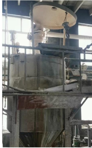
设备集气罩废气收集
